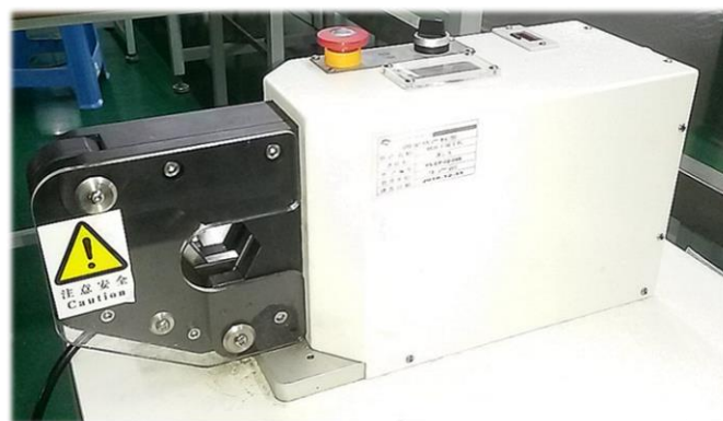
环形铆压机 Crimping machine
